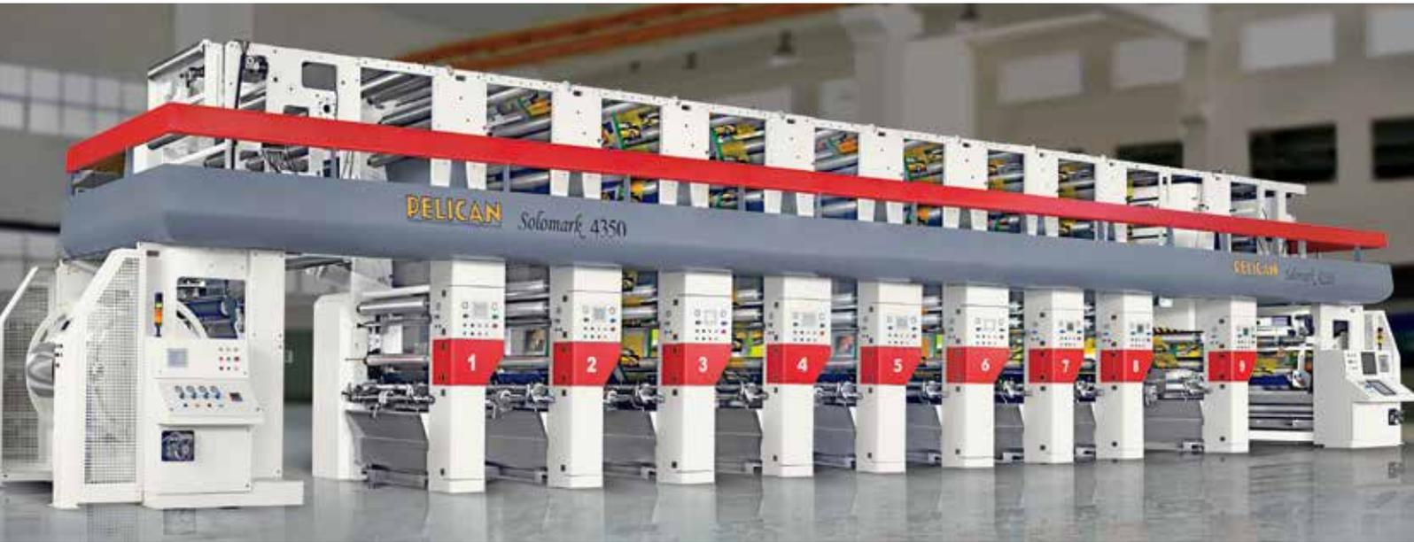
凹版印刷机具有可变的印刷规格长度、不同的印版直径、不同的印刷承印材料和连线印后设备等特点。以西门子成熟的驱动技术和自动化技术为基础，可以用最佳的方式满足这种变化多样的需求。
